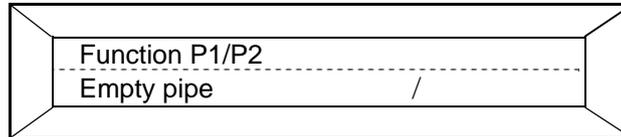
접점 동작은 empty pipe detector가 작동할 때 배관이 비어 있다는 상태를 나타냅니다. DATA를 누르면 다음과 같은 내용이 표시됩니다.
